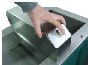
Werkzeugloses Öffnen der Abdeckung
