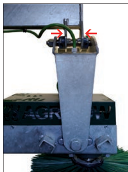
Brosse pendulaire - points de lubrification
